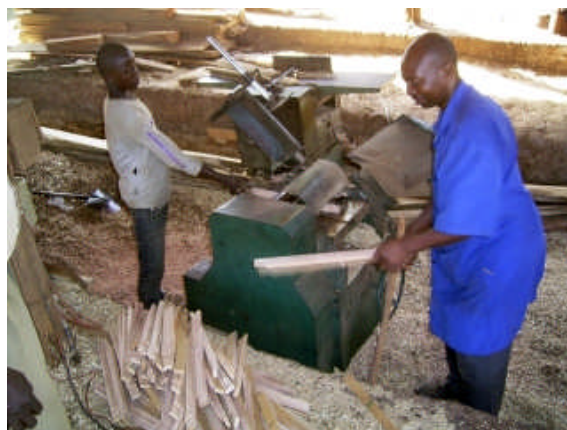
モシの製材所で改良養蜂箱用のトッパーを製作中
